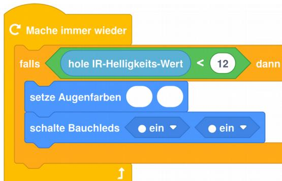
Teste dein Programm z.B. mit einem Zelt aus Papier: Was macht der Bob, wenn's dunkler wird? Gehen dann automatisch alle Lampen an?
