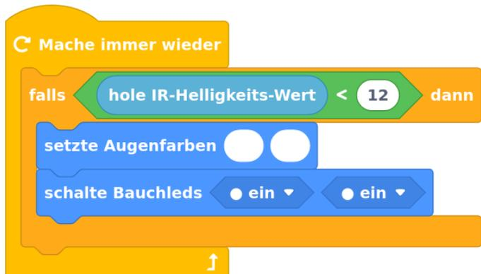
Teste dein Programm z.B. mit einem Zelt aus Papier: Was macht der Bob, wenn's dunkler wird? Gehen dann automatisch alle Lampen an?
